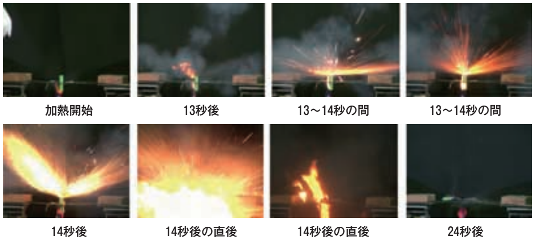
図6 封口後（充電率100%）の実験結果
