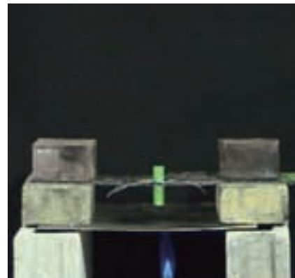
図8 1.6mmの鋼板による遮炎効果 着火してから20分間加熱するが、 電池に変化は見られず。 (表面温度：17.8℃→43.1℃)
