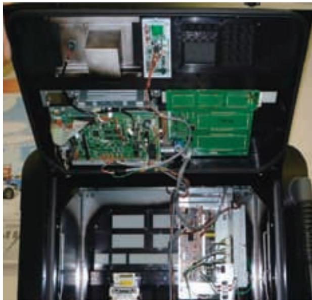
写真2 ペーパーバリアの設けられている固定給油設備のカウンターパネル内部の状況
