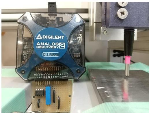
図 PTU-1 涡電流探傷器
