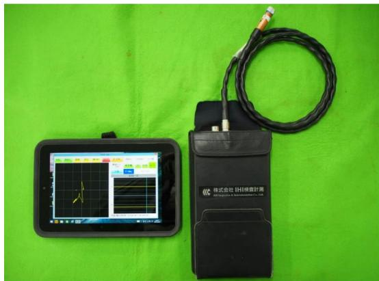
(1) 漩電流探傷装置(Mobile EDDy®)
