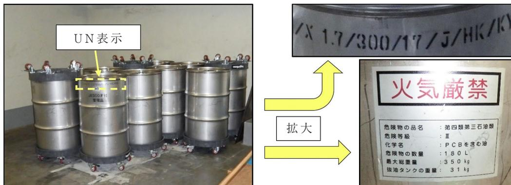
写真5 PCB運搬容器
