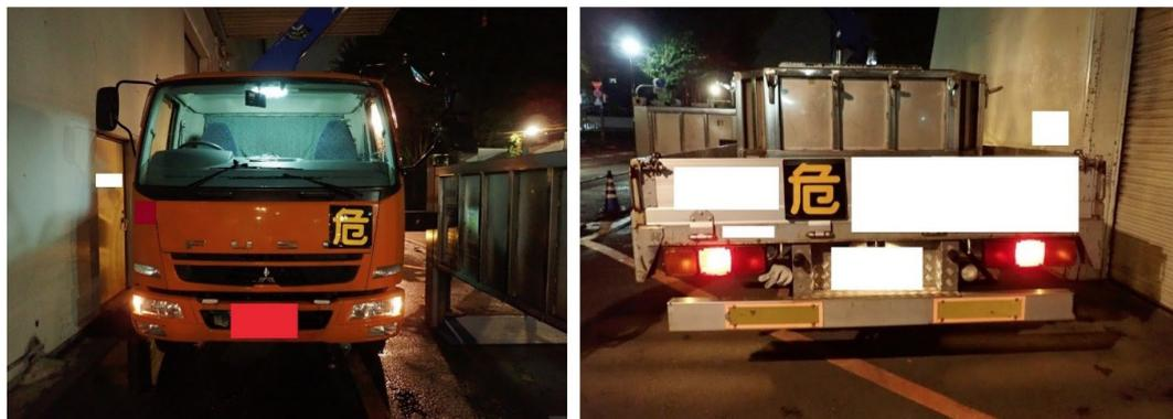
写真6 PCB運搬容器積載車両
