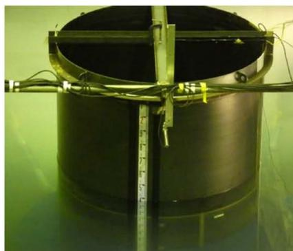
図9 対策工法1 浸水実験
