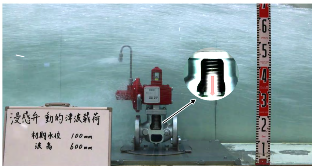
図.4 50A浸感弁の津波実験
