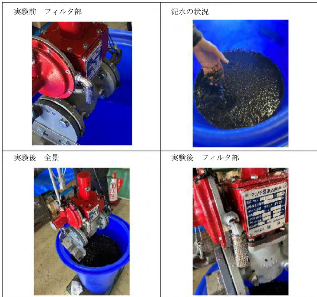
図.3 50A浸感弁の濁った水への水没実験
