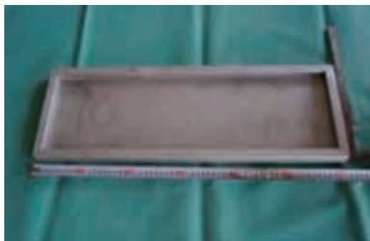
写真3 作成した防油堤
