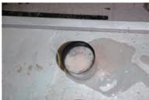
写真21 液面が完全にシールされている（ガソリン）
