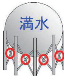
図-1 地震で球形タンクの柱が折れる
