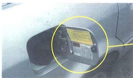
図2(iv) ハイオクガソリン用シールを作成して実際に貼り付けした状態
