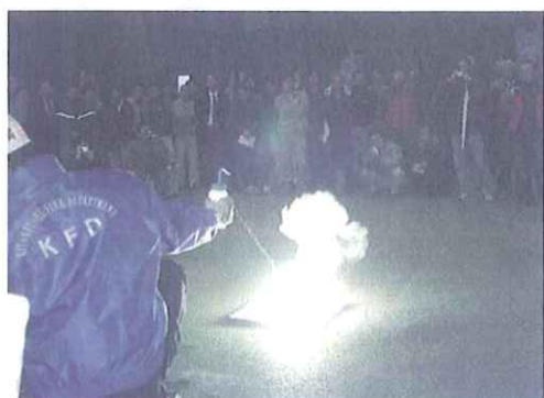
写真3 燃焼するマグネシウム粉への注水実験
