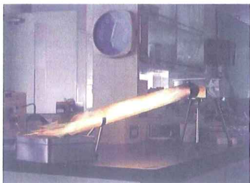
写真5 ガソリンペーパー引火実験
