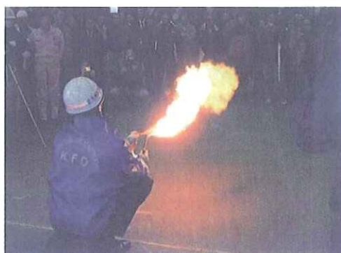
写真4 スプレー缶の引火実験
