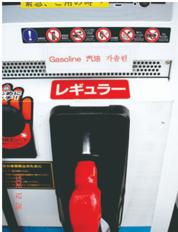
ガソリンの危険物標示板
