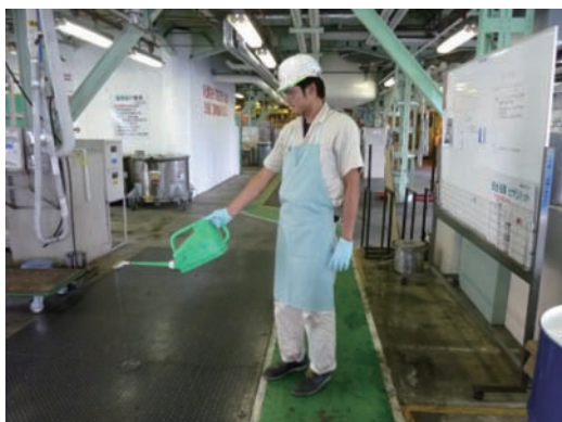
写真7 コンクリート床面への水散布状況と鉄板敷きの状態
