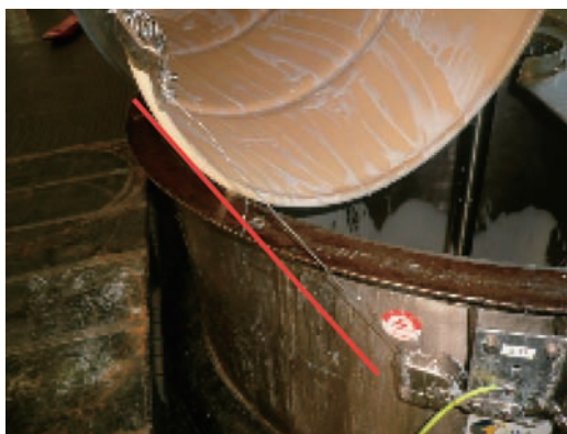
写真2 タイプA：自動巻取り式アース線の使用状況
