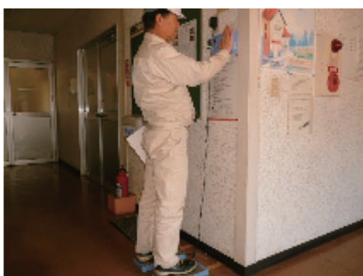
写真8 チェッカーによる作業員の導通チェック（毎朝、全員）
