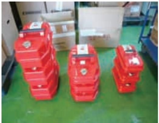
写真6 2個の同型容器を積み重ね1時間保持した状況
