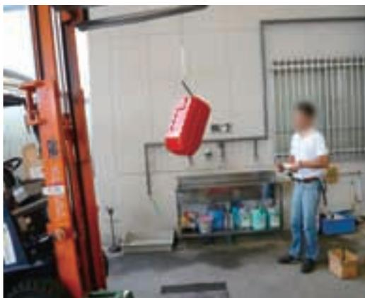
写真1 高さ1.2m から対角落下させる状況
