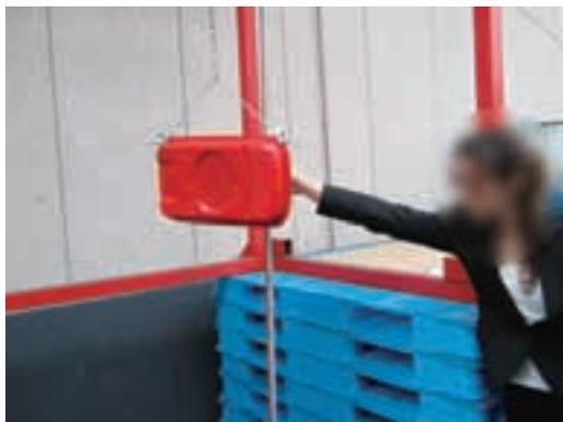
写真2 高さ1.2m から水平落下させる状況
