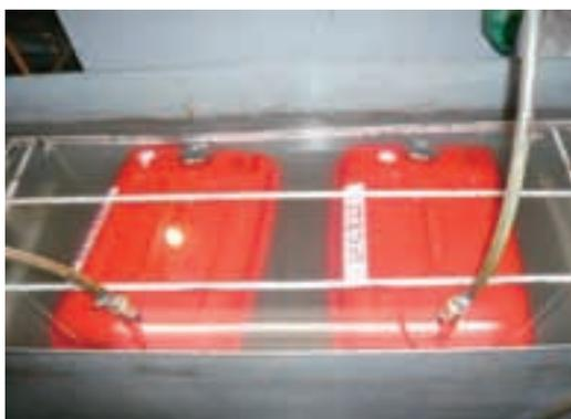
写真3 試験圧力49kPa で1分間保持した状況
