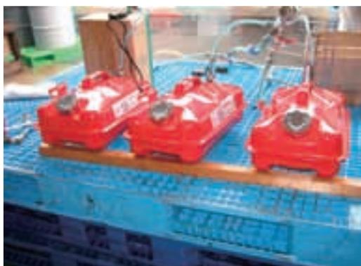
写真4 試験圧力250kPa で5分間保持した状況
