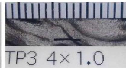
写真39 TP3 放電加工溝3 外観(拡大)
