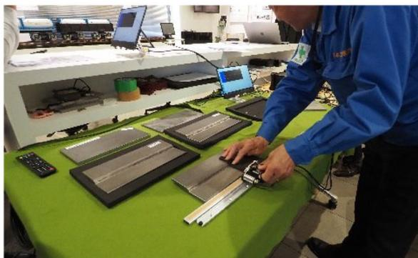
写真2 探傷試験の状況
