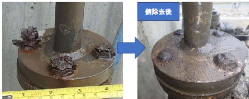
【ステンレス鋼製フランジと炭素鋼製ボルト・ナットの組合せによる 異種金属接触腐食の実例】
