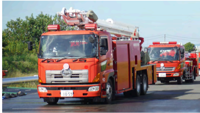
前方：大型化学高所放水車 後方：泡原液搬送車
