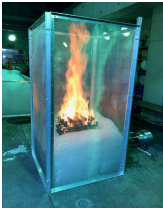
泡発泡装置を用いた消火実験 [消防研究センター]
