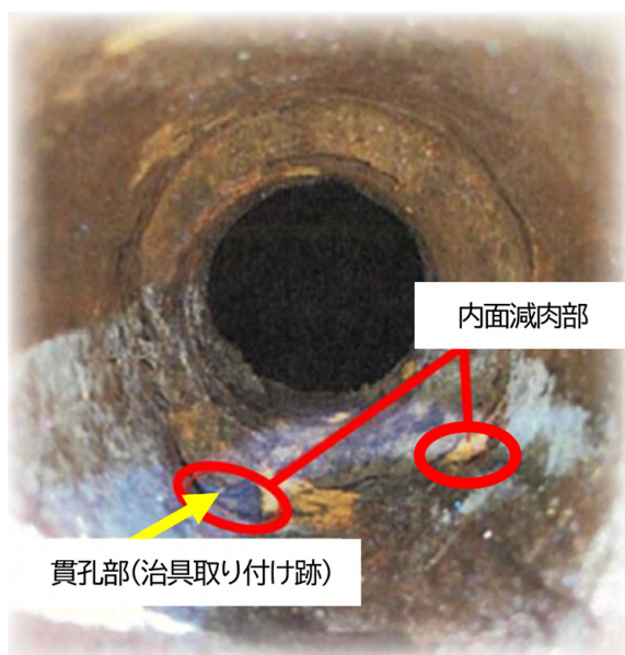
2Bノズル内部の様子
